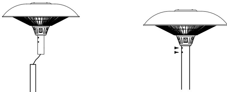
Trin 7: Skru strømledningen på foden med 4 stk. M4 skruer.
