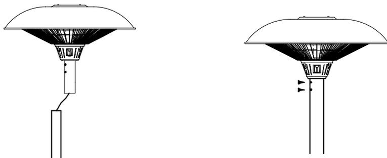
Steg 7: Fäst strömkabeln till basen genom att använda 4 st M4-skruvar.
