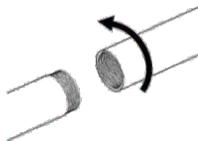
Vaihe 4: Hæv det øverste rør til den ønskede højde ved at skrue på fastgørelsesskiven.
