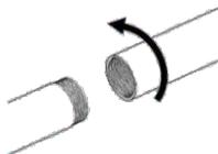
Steg 4: Höj det övre röret till önskad höjd genom att skruva på fästratten.
