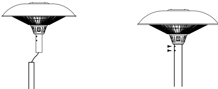
Vaihe 7: Kiinnitä virtajohto alustaan neljällä M4-ruuvilla.
