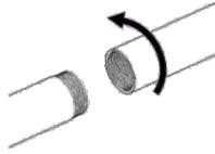
Vaihe 4: Nosta yläputki haluttuun korkeuteen ruuvaamalla kiinnitysvalitsin.
