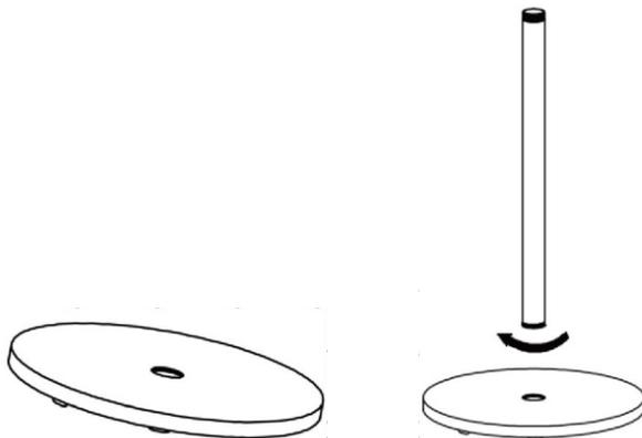
Trinn 2: Før strømkabelen gjennom basen og bunnrøret, og trekk gjennom ca. 2m kabel.
