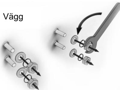
Steg 3:Montera värmaren på väggen och sätt sedan tillbaka fjäderlåsbrickorna, enkla brickorna och muttrarna och dra sedan åt med nyckeln.
