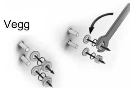
Trinn 3: Monter varmeapparatet på veggen, sett på fjærlåseskiver, skiver og muttere, og stram med skiftenøkkelen.
