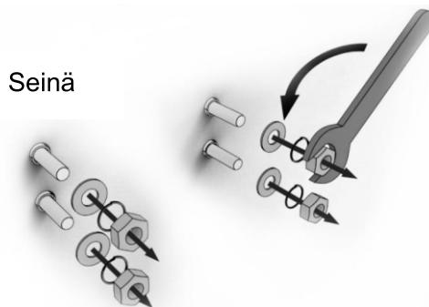
Vaihe 3:Asenna lämmitin seinälle, sen jälkeen laita takaisin jousilukkoaluslaatat, sileät aluslaatat ja mutterit paikoilleen, sen jälkeen kiristä kiintoavaimella.
