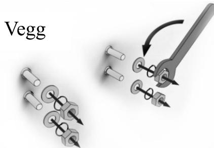
Trinn 3: Monter varmeapparatet på veggen, sett på fjærlåseskiver, skiver og muttere, og stram med skiftenøkkelen.
