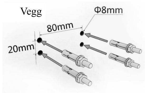
Trinn 2: Ta muttere, fjærskiver og skiver av de fire eksplosive boltene. Ta vare på dem for neste trinn.
