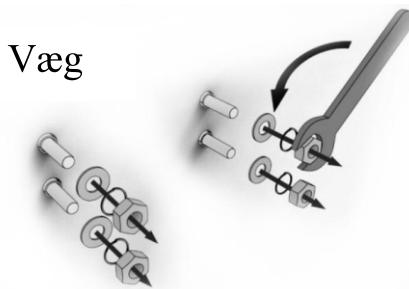
Trin 3:Monter varmeapparatet på væggen, sæt fjederskiver, skiver og møtrikker på igen og spænd til med skruenøglen.
