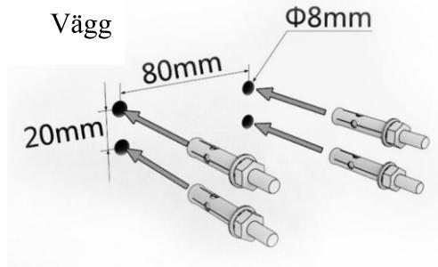
Steg 2: Ta bort muttrarna, fjäderlåsbrickor och enkla brickor från de fyra sprängbultarna. Behåll dem för nästa steg.
