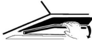
3. Kierrä molemmilla puolilla moottoria olevia hiilisuodattimia vastapäivään. Vaihda hiilisuodattimet uusiin.
