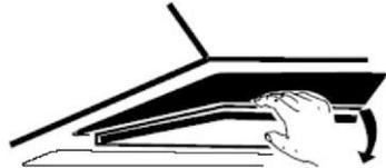
3. Vrid kolfiltret på båda sidor om motorn moturs. Byt kolfiltren med mot nya kolfilter.
