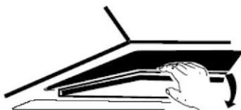
3. Drej kulfilteret på begge sider af motoren mod uret. Udskift kulfiltrene med nye.
