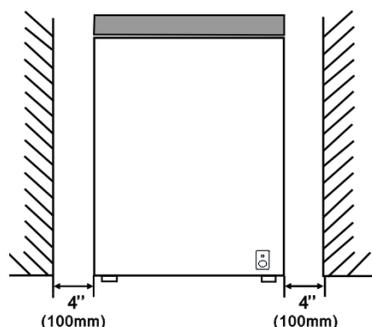
Forsikre deg om at det er tilstrekkelig plass rundt apparatet for å sikre fri luft sirkulasjon. Ideelt sett må det være et mellomrom på ikke mindre enn 10 cm rundt fryseren, og sørg for at du tillater hull som vist.
