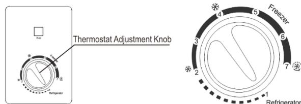
Frysens inre temperatur regleras av termostats justeringsknapp.
