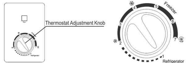
Pakastimen sisälämpötilaa voidaan säätää termostaatin säätökytkimellä.
