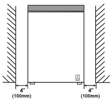
Se till att det finns tillräckligt med utrymme runt apparaten för att säkerställa fri luftcirkulation. Helst måste det finnas ett utrymme på minst 10 cm runt frysen och se till att du tillåter luckor som visas.
