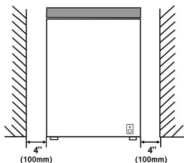
Sørg for, at der er tilstrækkelig plads omkring apparatet til at sikre fri luftcirkulation. Ideelt set skal der være et rum på ikke mindre end 10 cm omkring fryseren, og sørg for, at du skaber plads som vist.
