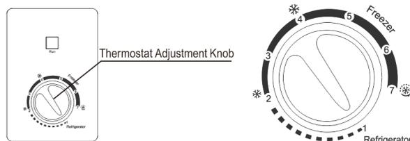
Innetemperaturen på fryseren reguleres av justeringsknappen for termostaten.
