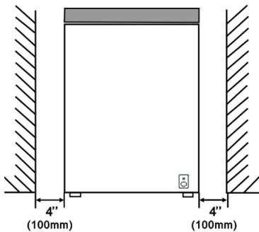
Varmista, että laitteen ympärillä on riittävästi vapaata tilaa ilman kierron varmistamiseksi. Ihannetapauksessa pakastimen ympärillä on vähintään 10 cm tilaa, kuten kuvassa on osoitettu.
