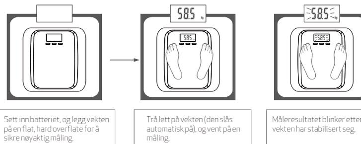
Sett inn batteriet, og legg vekten på en flat, hard overflate for å sikre nøyaktig måling.
