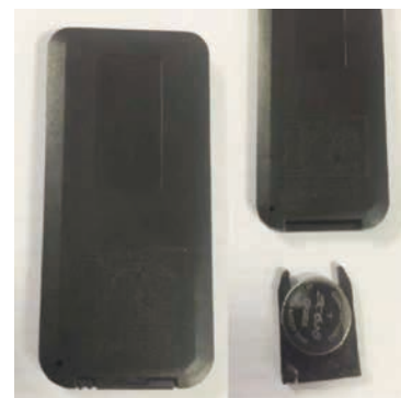
Skjut fliken till höger så att batterihöljet kan tas bort.
