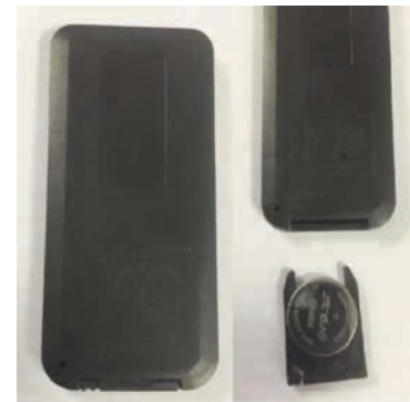
Paina liuskaa oikealle irrottaaksesi paristokotelon.
