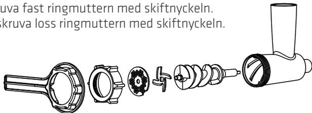
\* Tips för enkel demontering: Använd en sked för att lossa skärbladet och hålskivan från axeln.
