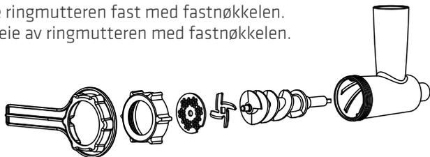
\* Tips for enkel demontering: Bruk en skje til å løsne skjærebladet og kverneskiven av skaftet.
