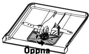
1. Håll i grovfiltret och vrid det moturs för att låsa upp det. Lyft upp filtret och ta ut det ur diskmaskinen.
