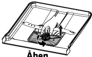
1. Tag fat i det grove filter, og drej det mod uret for at låse filteret op. Løft filteret op og tag det ud af opvaskemaskinen.
