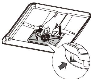
3. Større mængder madrester kan rengøres ved at skylle filteret under rindende vand. Brug en blød rengøringsbørste til en mere grundig rengøring.
