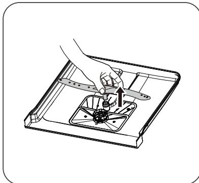
1. Kun haluat irrottaa ylemmän suihkuvarren, pidä mutteria keskellä paikallaan ja irrota suihkuvari kiertämällä sitä vastapäivään.
