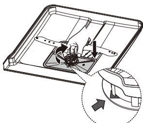
3. Større matrester kan fjernes ved skylle filteret under rennende vann. For å rengjøre mer grundig kan du bruke en myk børste.
