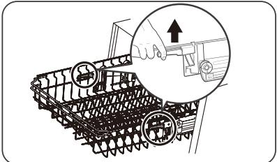
1. För att höja den övre korgen lyfter du bara den övre korgen i mitten på vardera sidan tills korgen låses på plats i det övre läget. Det är inte nödvändigt att lyfta justeringshandtaget.
