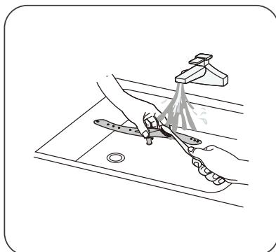
3. Tvätta spolarmarna i diskmedel och varmt vatten och använd en mjuk borste för att rengöra munstyckena. Sätt tillbaka dem när de sköljts noga.
