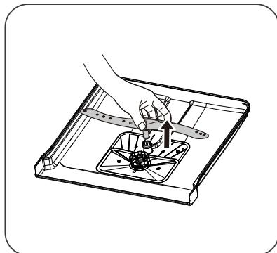
1. Ta bort den övre spolarmen genom att hålla fast muttern i mitten och vrida spolarmen moturs för att ta bort den.
