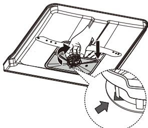
4. Sätt tillbaka filtren i omvänd ordning, sätt tillbaka filterinsatsen och vrid medurs till stängningspilen.
