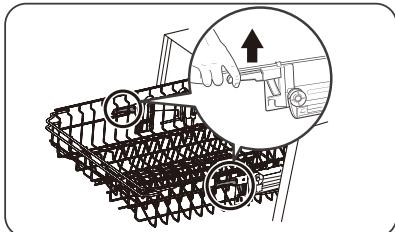
1. For at hæve den øvre kurv, skal du blot løfte den midt på hver side, indtil den låses på plads forneden. Du behøver ikke at løfte justeringshåndtaget.
