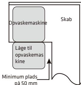
**Trin 2. Trin til installation af opvaskemaskinen**
