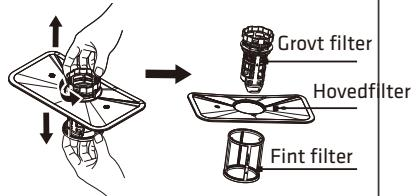
1. Hold i det grove filteret, og drei det mot klokken for å løse opp filteret. Løft filteret oppover og ut av oppvaskmaskinen.
