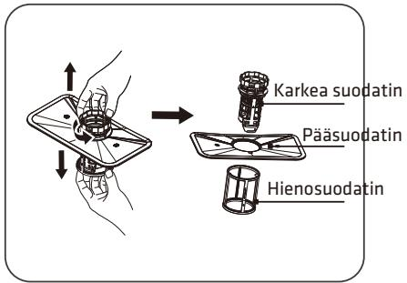
1. Pidä kiinni karkeasuodattimesta ja käännä sitä vastapäivään suodattimen lukituksen avaamiseksi. Nosta suodatin ylöspäin ja ulos astianpesukoneesta.
