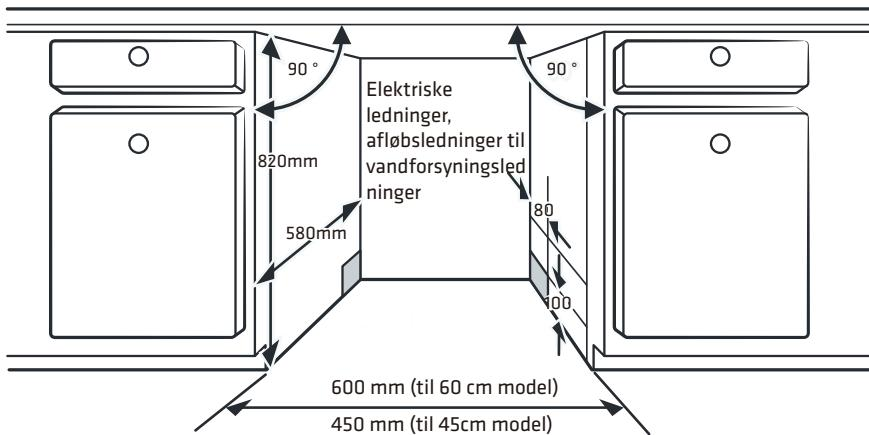
2. Hvis opvaskemaskinen opstilles i hjørnet af skabet, skal der være plads til at lågen kan åbnes.
