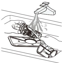
2. Det fine filteret kan trekkes fra bunnan av filterenheten. Det grove filteret kan løsnes fra hovedfilteret ved å klemme tappene forsiktig og trekke det bort.
