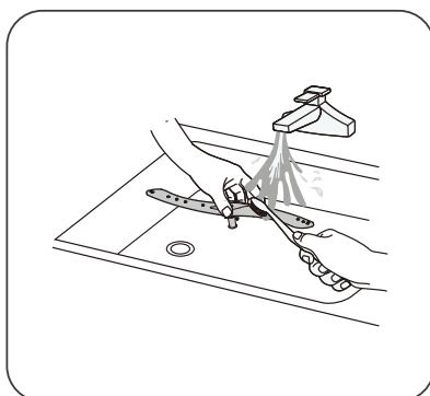
3. Vask armene med varmt såpevann, og bruk en myk børste til å rengjøre dysene. Skyll dem grundig og sett dem på plass igjen.
