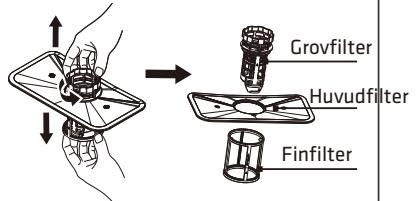
2. Finfiltret kan dra upp från botten av filterenheten. Grovfiltret kan lossas från huvudfiltret genom att man trycker på flikarna i ovankanten och drar av.
