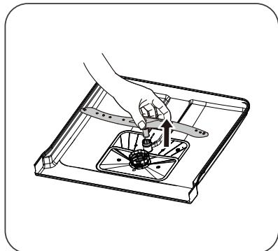
1. For at fjerne den øverste sprøjtearm, skal du holde møtrikken i midten fast og dreje armen med uret for at tage den af.
