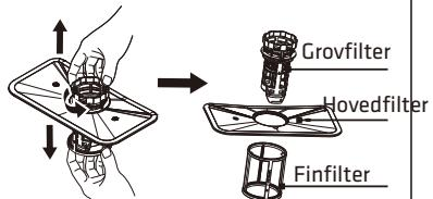
1. Tag fat i det grove filter, og drej det mod uret for at låse filteret op. Løft filteret op og tag det ud af opvaskemaskinen.
