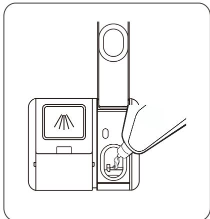
2. Hæld afspændingsmidlet i beholderen. Undgå, at fyldes den for meget op.
