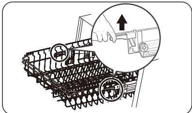
1. For å heve den øvre kurven løfter du bare den på midten av hver side til den låses på plass i øvre posisjon. Det er ikke nødvendig å løfte justeringshåndtaket.
