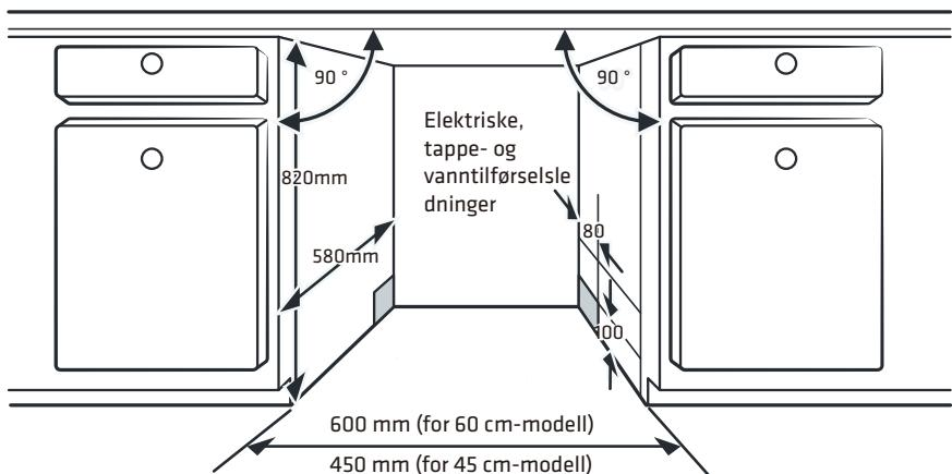
2. Hvis oppvaskmaskinen er installert i hjørnet av skapet, bør det være litt plass når døren åpnes.
