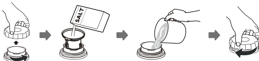
1. Ta bort korgen och skruva loss behållarens lock.
