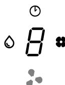
Betjeningsfeltet til kokesonene, avtrekksviften og Timer-enheten kan aktiveres ved å trykke på den aktuelle Digit-tasten.
